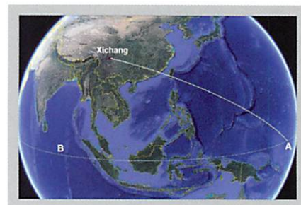
Het grondpad (op een niet roterende aarde) van de raketlancering op 13 mei 2013 vanaf Xichang naar het terugkeerpunt A op de evenaar (volgens NOTAM). Omdat de raket terugkeerde in punt B, moet hij minstens 30.000 km hoog gevlogen hebben om de aarde de tijd te geven om van punt B naar punt A te draaien. [allthingsnuclear.org]
