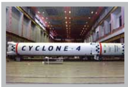
Eerste en tweede trap van de Cyclone-4 draagraket in assemblagelijnen van de Yuzhnoye fabriek in Dnjepropetrovsk. [SDO Yuzhnoye]
