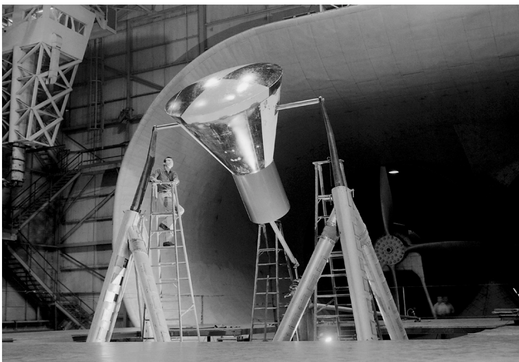
Een model van de Mercury capsule in een windtunnel van het Langley Research Center. [NASA]
