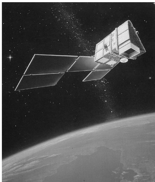
Helios. Operationele militaire observatiesatelliet. Door Frankrijk ontworpen en gebouwd (Matra), maar betaald vanuit een samenwerkingsverband tussen Frankrijk, Italië en Spanje. Resolutie zou één meter bedragen.
